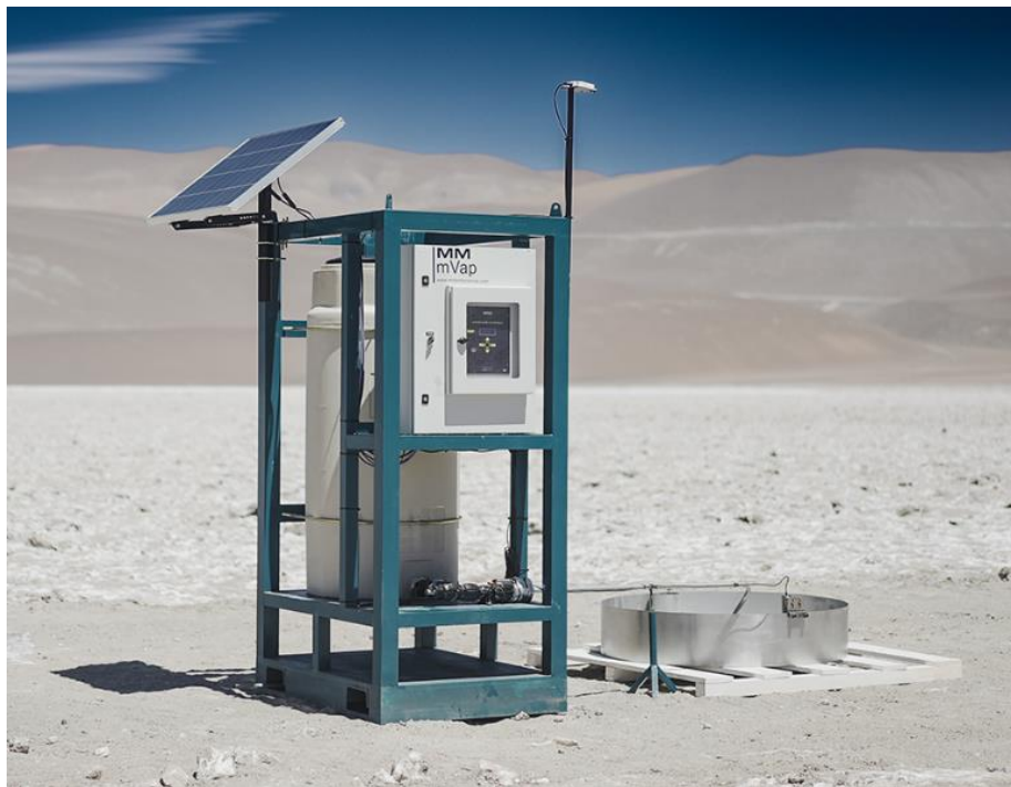
Figura 46 mVAP - Estación Evaporímetro Automático
