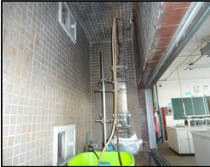
Figura 2. Dispositivo de extracción tipo Soxhlet para procesar el material biológico
