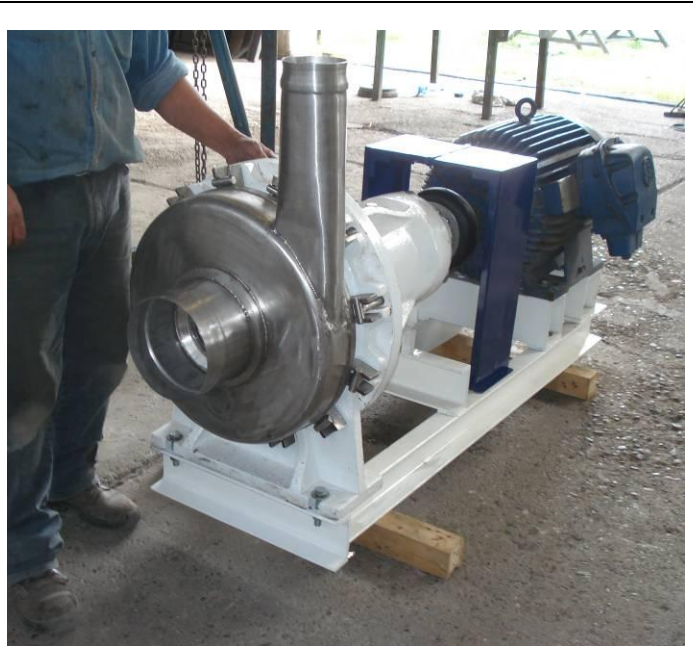
Figura 3: Bomba 40 HP armada Fuente Rubio y Asociados
