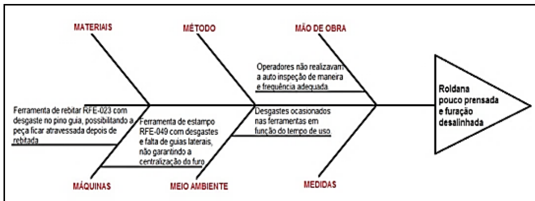
Figura 10: Diagrama de Ishikawa com o efeito provocado na roldana analisada
