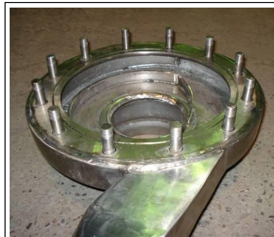
Figura 4: Interior voluta bomba 30 HP para jugo de tomate a 8° Brix Fuente Rubio y Asociados
