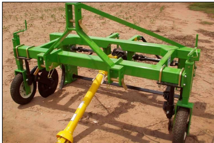
Figura 2. Arrancadora de cebollas AC160, marca Escañuela.
