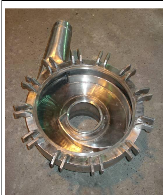
Figura 2: Interior voluta bomba 40 HP para jugo de tomate a 21° Brix Fuente Rubio y Asociados
